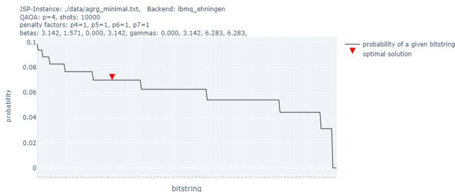
Abbildung 34 Exemplarische Wahrscheinlichkeitsverteilung der Lösungen bei Nutzung des QAOA-Ansatzes auf dem IBM System One (optimale Lösung rot markiert)
