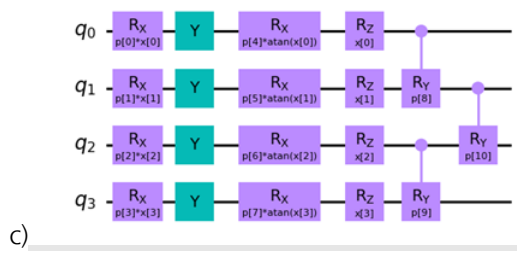
Abb. 50 Ergebnisse der Rechnungen auf IBM Q Quantencomputer a) Ergebnis einer QSVR aufbauend auf einer weiteren Version (V2) der künstlich generierten Feature-Map. b) Ergebnis einer QSVR aufbauend auf einer weiteren Version (V3) der künstlich generierten Feature-Map. c) Version 3 der generierten Feature-Map mit bester Leistung auf der Hardware
