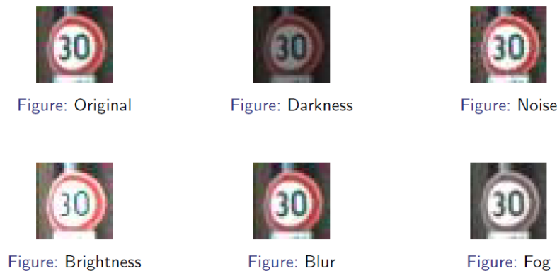
Abb. 44 Beispiele für verschiedene Verfremdungen. Ziel ist es sicherzustellen, dass die Klasse unter Einfluss der Transformationen erhalten bleibt.
