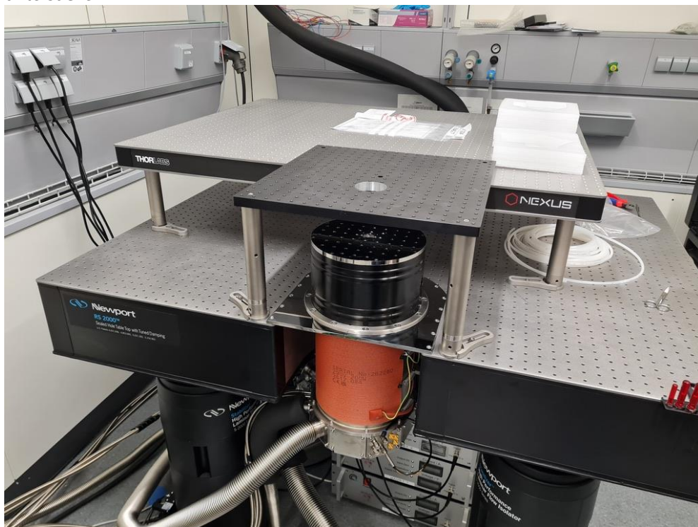
Abb. 26: mK-Kryostat installiert in Ulm und integriert in einem optischen Tisch, um das nötige sehr geringes Vibrationsniveau zu erreichen.
