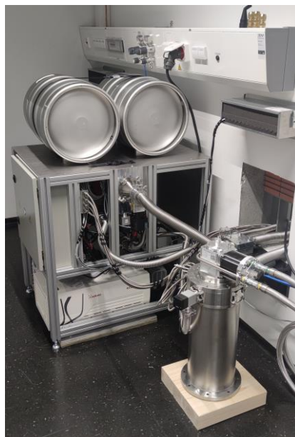
Abbildung 25: (links) mK-Kryostat installiert in Stuttgart und integriert in einem optischen Tisch, um das nötige sehr geringes Vibrationsniveau zu erreichen. (rechts) Gashandling System installiert in einen Nebenraum, um akustischen Lärm und Vibrationen zu entkoppeln.
